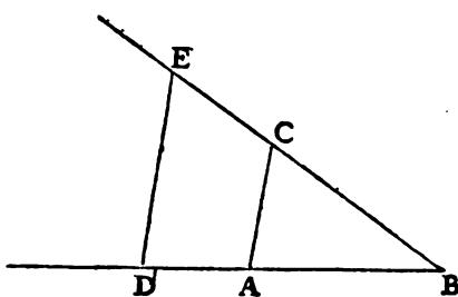
Soit par exemple A B l'vnité, & qu'il faille multiplier B D par B C, ie n'ay qu'a ioindre les poins A & C, puis tirer D E parallele a C A, & B E est le produit de cete Multiplication.
